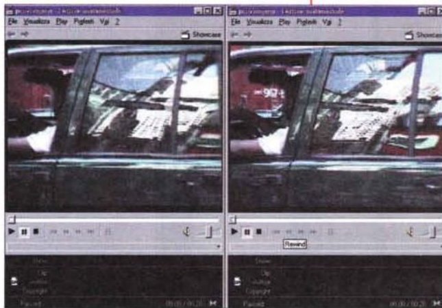
Confronto diretto tra gli stessi fotogrammi di un filmato codificato: a sinistra in MPEG-4, a destra in Morgan MJPEG. A voi il giudizio.
